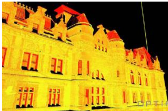
그림 12. 기존 건축물의 레이저 스캔 결과물 (출처: GSA)
