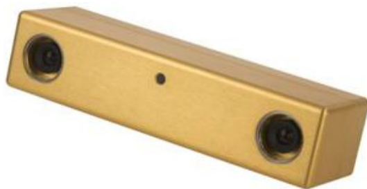
그림 9. 포인트그레이 리서치 (Point Grey Research, Inc.)의 스테레오 비전 카메라인 범블비2 (Bumblebee 2) (출처: 포인트그레이 리서치 웹사이트)
