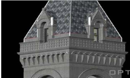
그림 14. 스캔 결과물을 바탕으로 모델링한 BIM 모델 상세 (출처: GSA)
