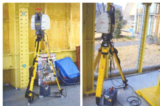
그림 7. 고정밀 스캐너(Shape Grabber)의 현장 설치 모습 (출처: 와세다대학교(嘉納) 연구소)
