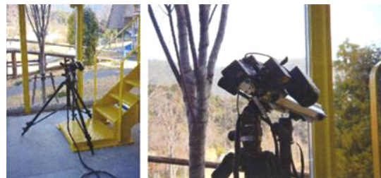
그림 5. 광대역 스캐너(Leica HDS 3000)의 현장 설치 예. (출처: 와세다대학교(嘉納) 연구소)
