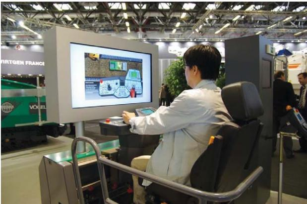
그림 5. 노면포장장비 시뮬레이터
