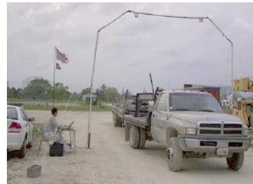
그림 7. 벡텔의 파이프 인식 테스트 - CII, FIATECH
