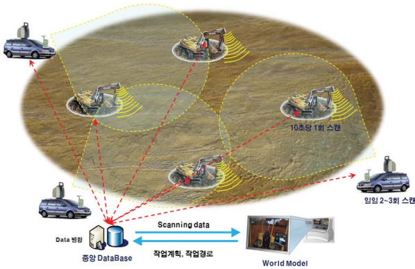
그림 4. World Model 기본 개념 (지능형 굴삭시스템 개발 최종보고서, 2011)
